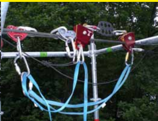
Seilbahn mit doppelter Sicherung
